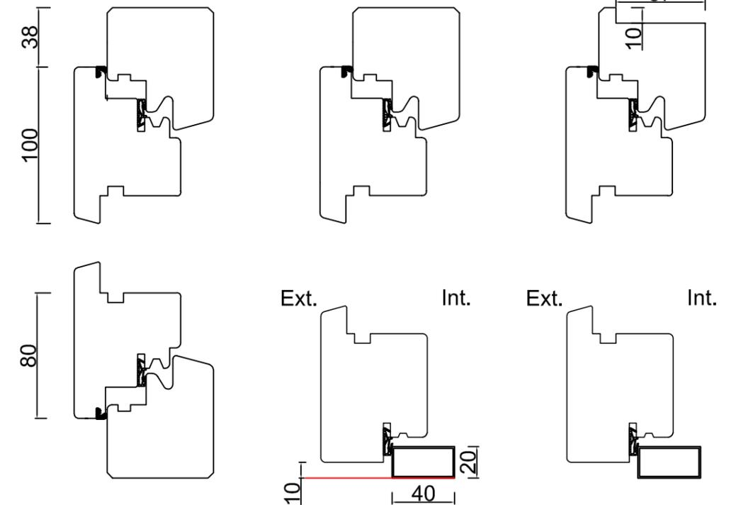
Porte-fenêtre crémone simple 1 ou 2 Vantaux - Epaisseur 68 mm
